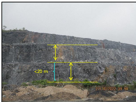
ภาพที่ 2.7 การทำเหมืองแบบขั้นบันได (Benching Method)
