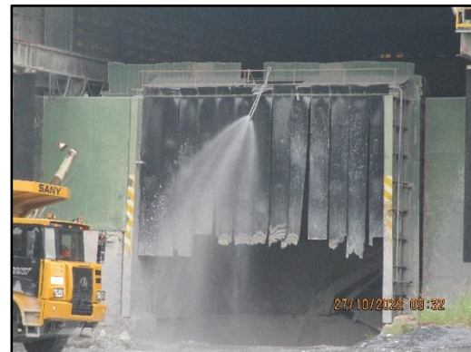
ภาพที่ 2.24 ระบบ Spray น้ำอัตโนมัติในกระบวนการบดย่อยหิน
